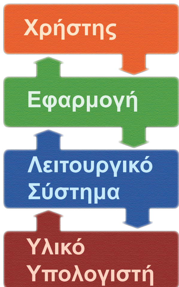
Εικόνα 2.1. Τυπική διαστρωμάτωση λογισμικού. Τα βέλη δείχνουν τη ροή της πληροφορίας.
